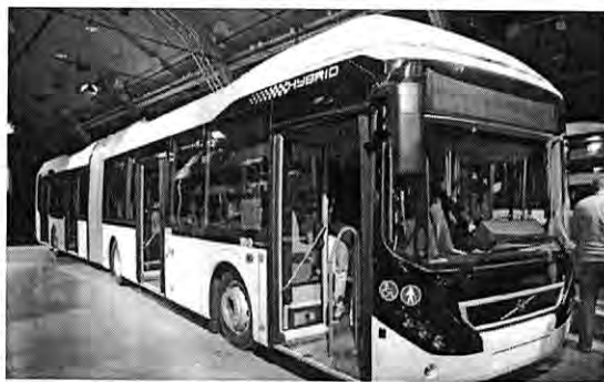
Figură 4-41 Autobuzul Volvo 7900 Hybrid (PHEV) cu posibilitate de încărcare a bateriilor
