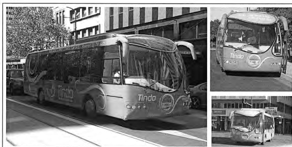
Figură 4-21 Tindo, primul autobuz dotat cu sistem de încărcare a bateriilor cu celule fotovoltaice
