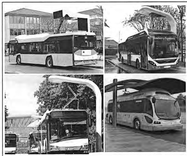
Figură 4-27 Utilizarea pantografului pentru încărcarea rapidă a autobuzelor electrice
