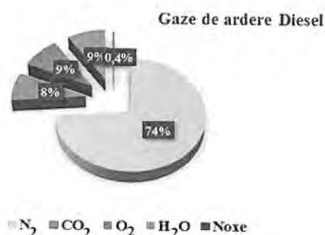
Figură 4-42 Gazele rezultate din procesul de ardere pentru motoarele Diesel
