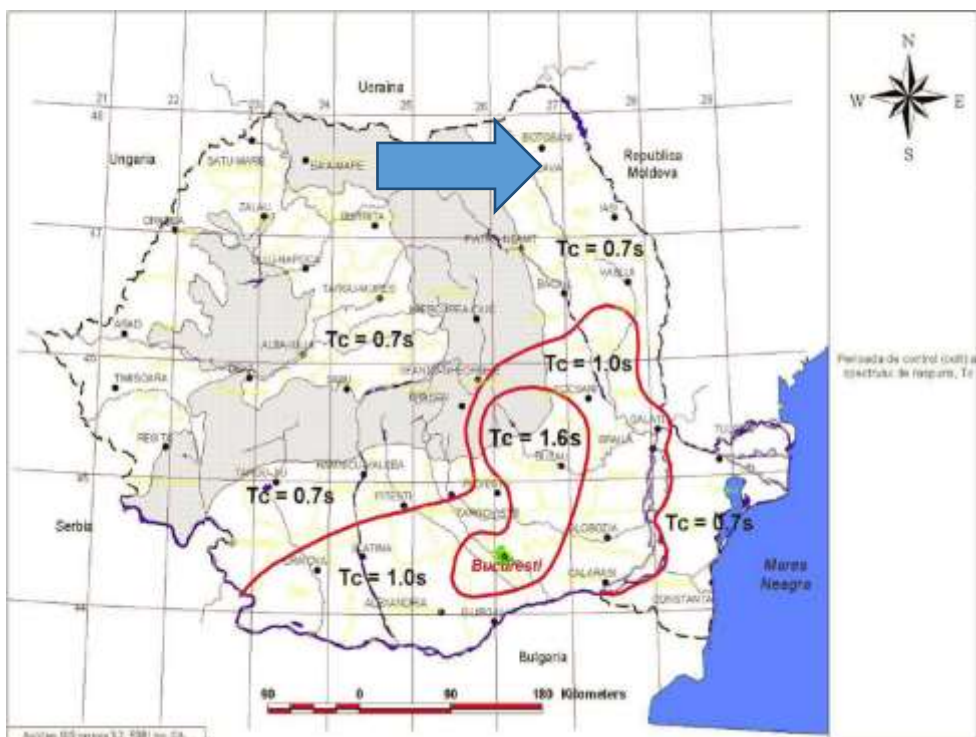
Fig.3.3 – Zonarea Teritoriului din punct de vedere al perioadei de control (colt) a spectrului de răspuns
