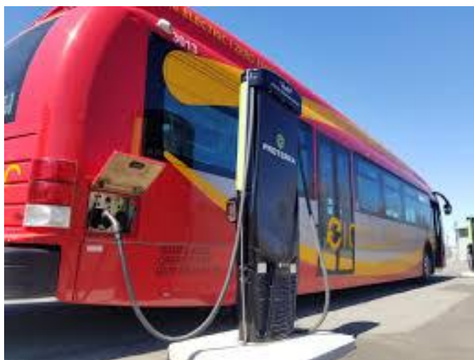
Figura 34 – Solutie de incarcare a bateriilor autobuzului electric cu cablu (sursa: DC Circulator Bus)
