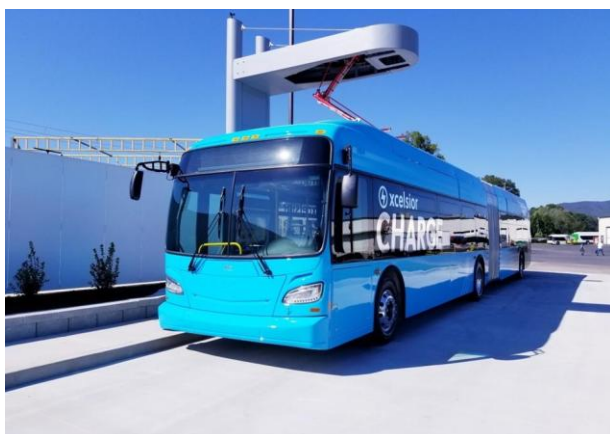
Figura 35 – Solutie de incarcare a bateriilor autobuzului electric – pantograf (sursa: ESVE Australia si Volvo Bus Suedia)
