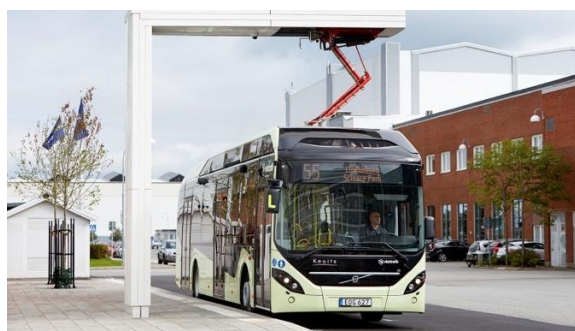
Figura 35 – Solutie de incarcare a bateriilor autobuzului electric – pantograf (sursa: ESVE Australia si Volvo Bus Suedia)
