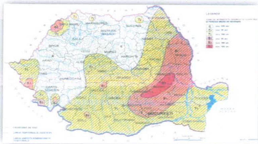
Zonarea seismică a teritoriului României.
