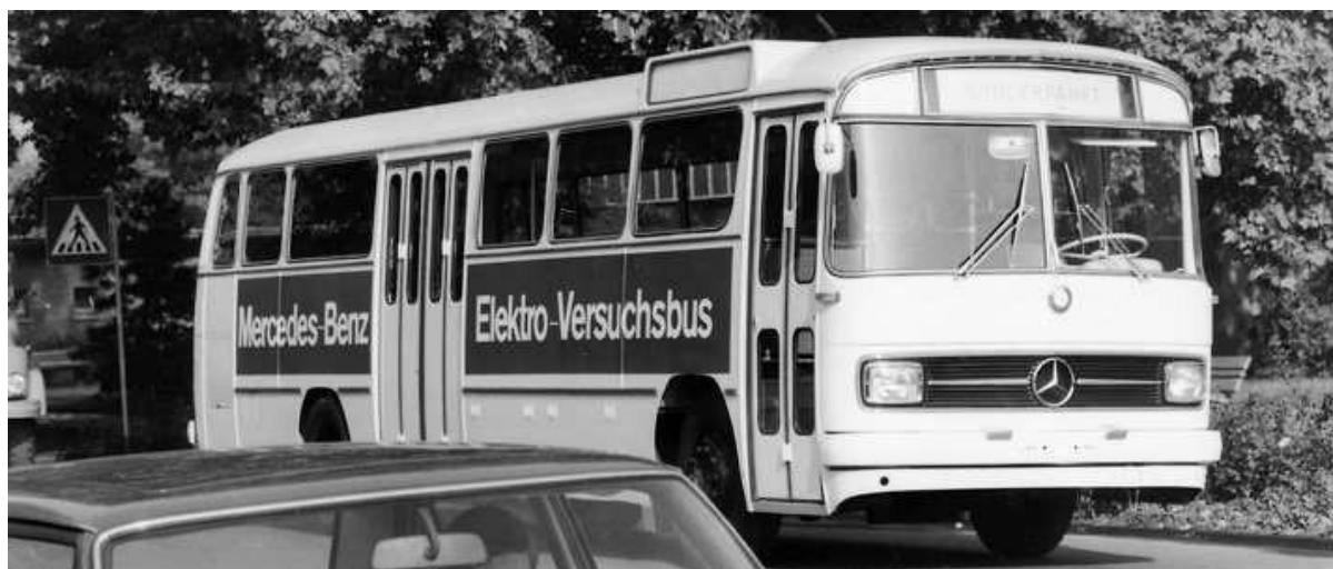
Fig. 12 Primul autobuz de testare electrică - un exemplu timpuriu al tehnologiei hibride de acționare
