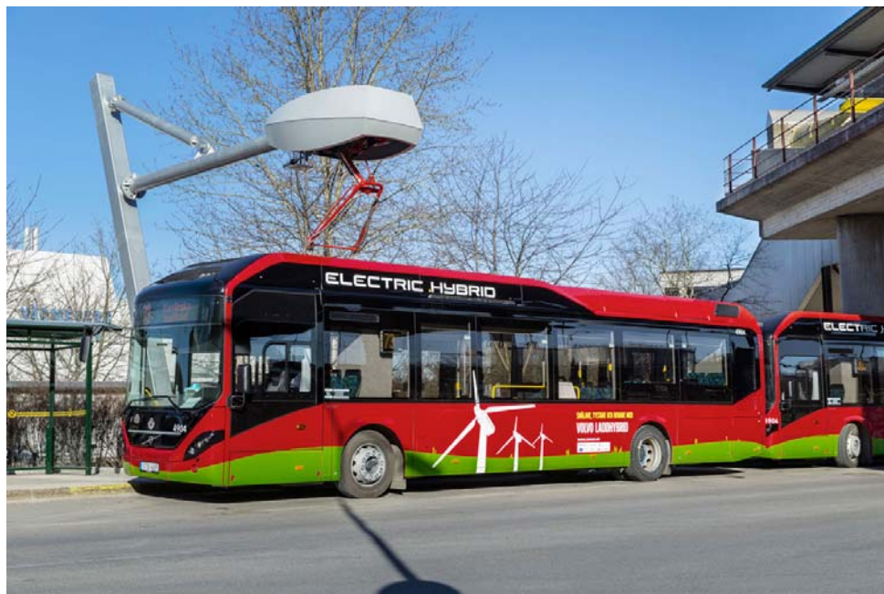
Stație de alimentare rapidă pentru autobuze electrice
