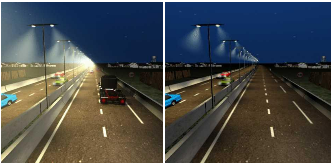
Fig. 10. Nivele de dimming în funcție de fluxul de trafic
