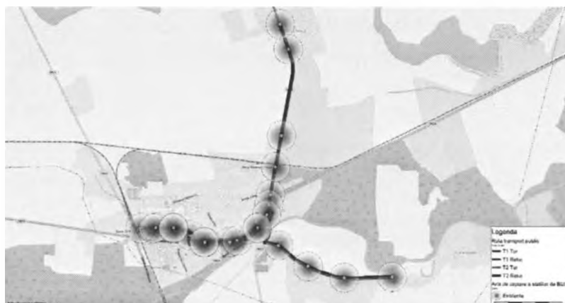
Fig. 6.5. Traseele de transport public și gradul de acoperire al acestuia (raza = 300 metri față de stații)
