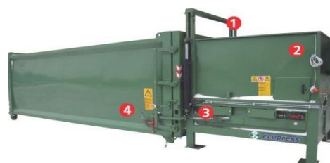
Figură 3-3 – Sistem de compactare fix al deșeurilor
