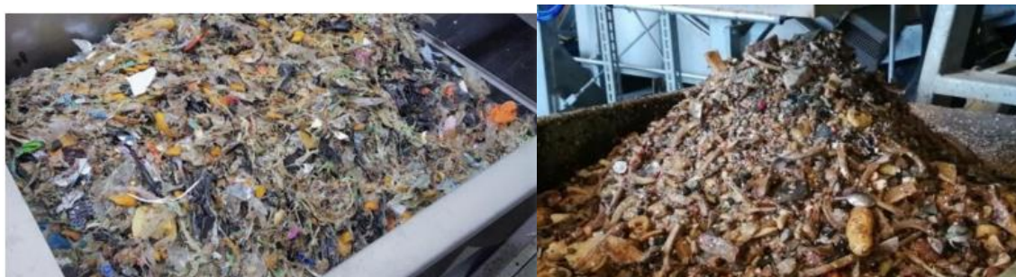
Figură 3-65 Frația ușoară și respectiv, fracția grea din pulper
