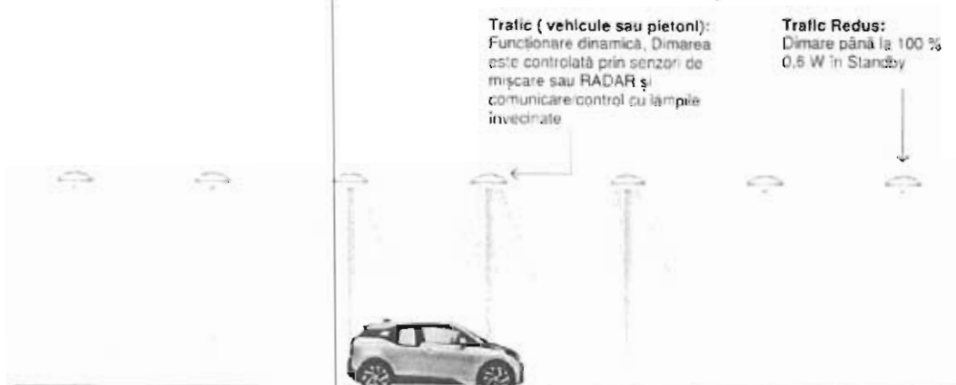
Fig.2: Arhitectura Sistemului de Telegestiune
