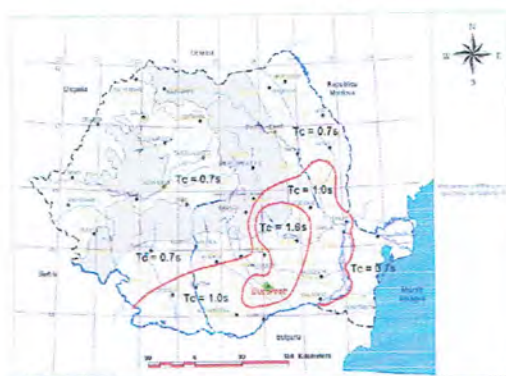
Fig. 2 - Zonarea teritoriului Romaniei in termeni de perioada de control (colt), TC a spectrului de raspuns
