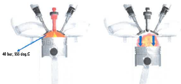
Figura 4.10. Arderea și destinderea la motoarele Diesel (Sursa: Learn Engineering).
