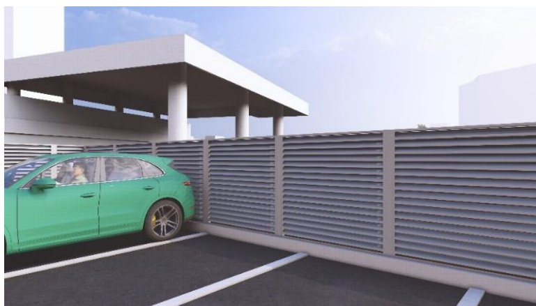
Figura 20 -Imagine 3D cu gardul pe limita de proprietate în zona II, din panouri metalice tip jaluzele cu lamele metalice orizontale. Textura panourilor de gard se inspiră din fațada lamelară orizontală a stadionului
