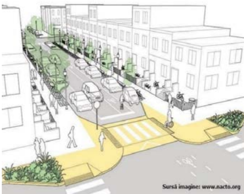
Figură 9-20 - Exemplu amenajare intersecții străzi tip „home-zone”
