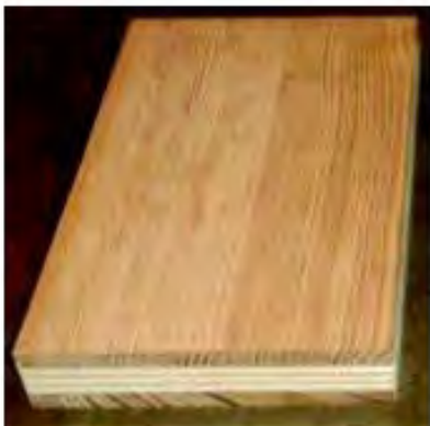
Stratificat cu fețe din Pitch Pine
