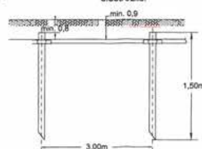
Adancimea de ingropare a electrozilor
