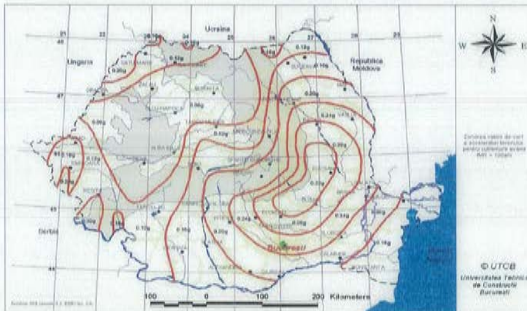
Figura 3.1 Zonarea teritoriului Romaniei in termeni de valori de vârf ale accelerației terenului pentru proiectare ag pentru cutremure avand intervalul mediu de recurentă IMR = 100 ani
