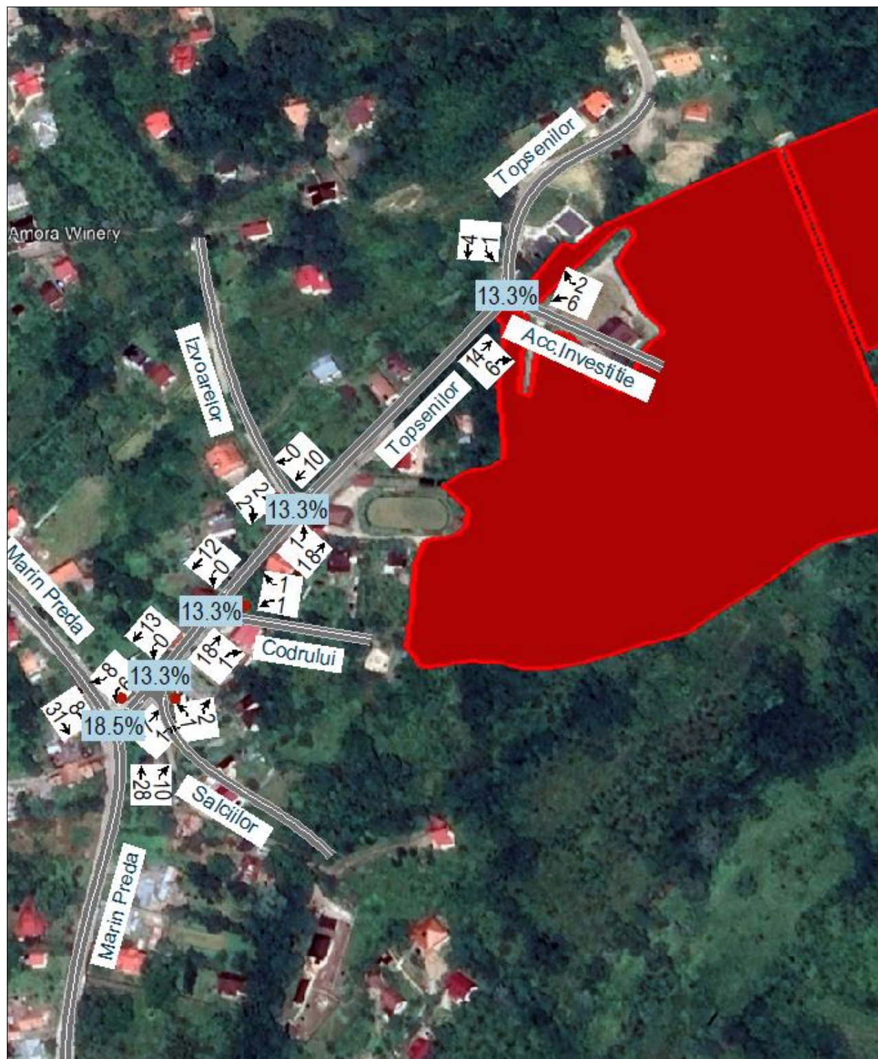
Fig.9 – Gradul de utilizare al intersecției (ICU)
