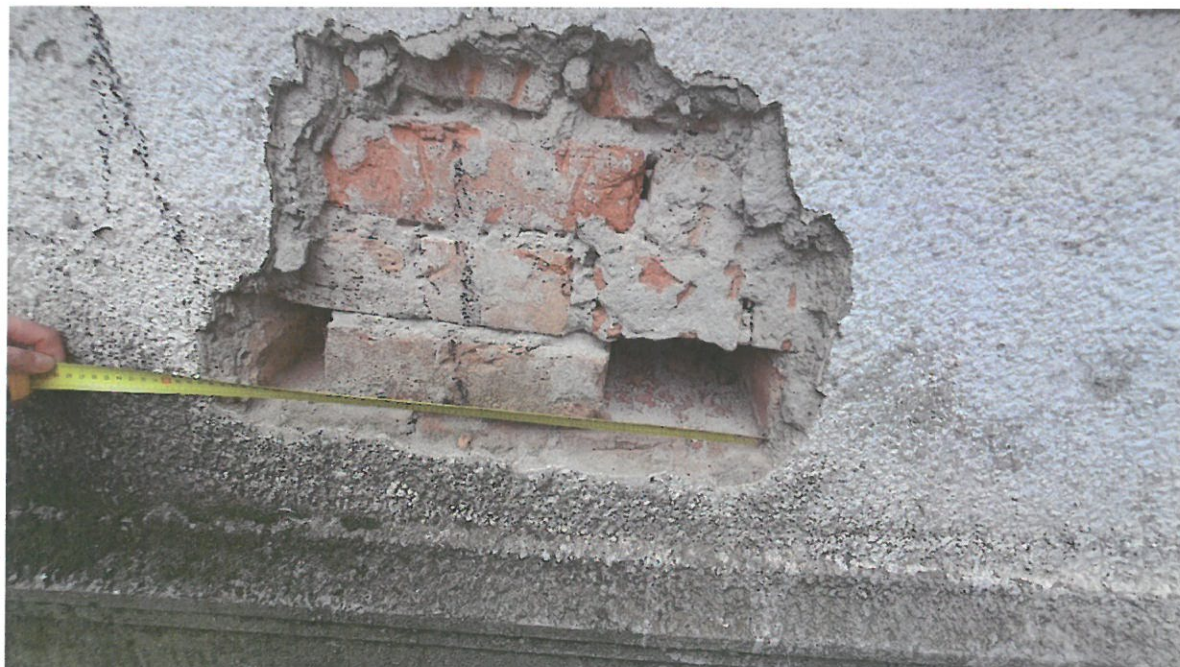
Figura 83: Zone de prelevare de probe, respectiv incercari de forfecare in rost;
