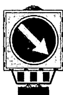
Panou pentru semnalizare ocolire lucrări
