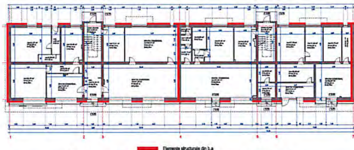
Fig. 11.1 – Măsurile de intervenție propuse – tronson 1
