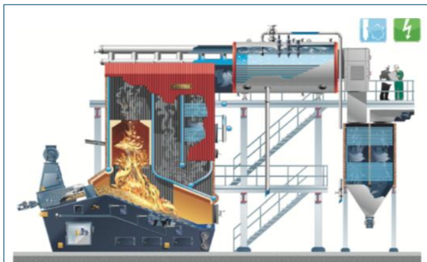
Figura 18. Cazan pentru arderea biomasei pentru cogenerare
