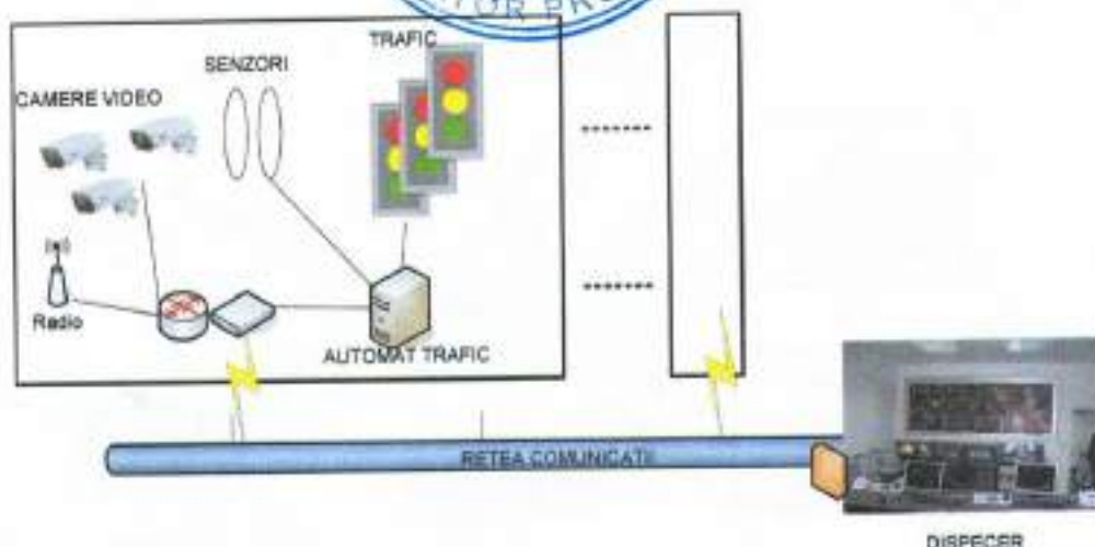
Figura 6 - Schema tipică de principiu a sistemului de supraveghere video de oraș
