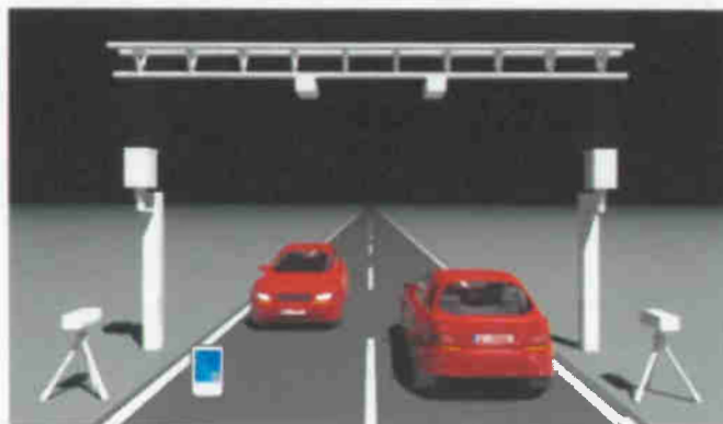
Figura 29 – Exemplu privind instalarea sistemelor ANPR
