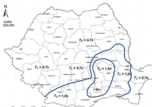
Fig. 2. Zonarea teritoriului în termeni de perioada de control (colț), T_c , a spectrului de răspuns.
