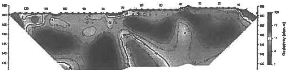
Secțiune geoelectrică de rezistivitate Inversată - ERT 25
