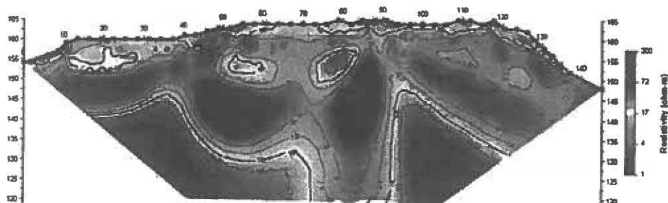
Secțiune geoelectrică de rezistivitate inversată - ERT 6
