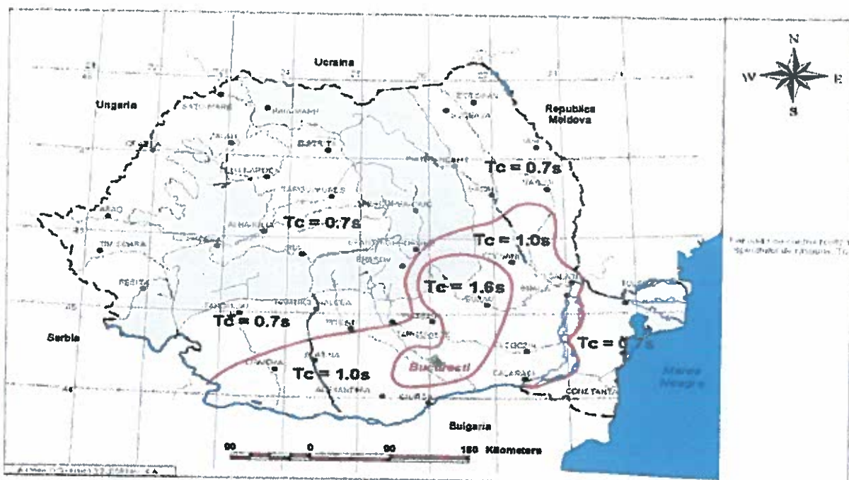
Zonarea teritoriului Romaniei in termeni de perioada de control (colt) T_c a spectrului de raspuns
