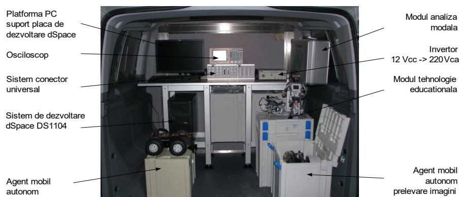
Fig.3. Laboratorul mobil de mecatronică- detaliere echipamente de bază.
